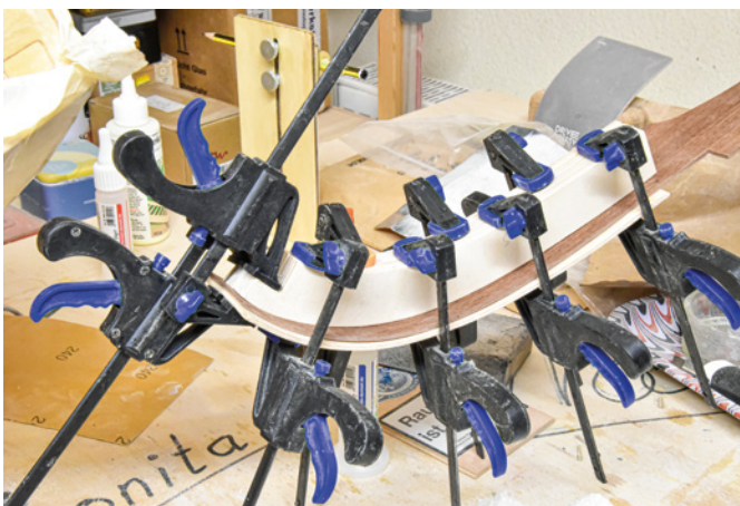
Die Kabinenwände werden gebogen
