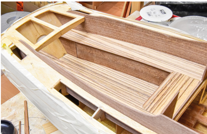
Die Plichtteile werden angepasst. Gut zu sehen ist hier das Zebrano-Holz
