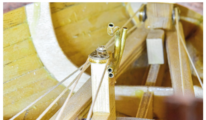
Wendepunkt der Umlaufschot für Groß und Wendefock sowie Zuführung der Schoten
