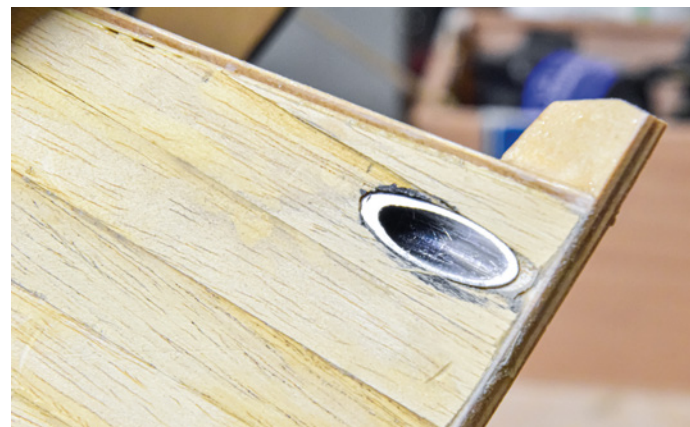
Und hier meine an den Rumpf angepasste Version. Wird der Bugspriet nicht gebraucht, wird die Öffnung mit einer Abdeckung verschlossen
