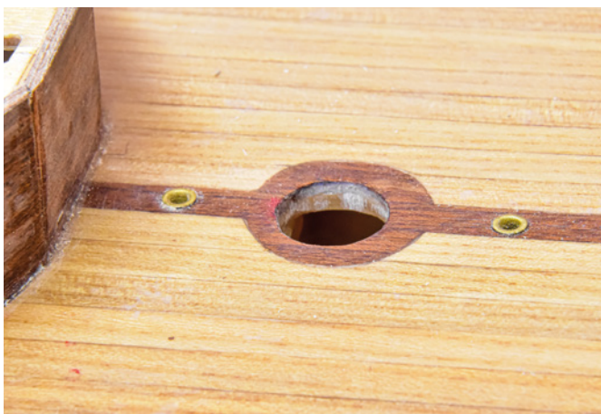
Mastfuß mit Schotdurchgängen
